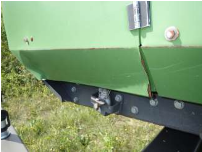
Schneidwerksverkleidung rechts verformt
